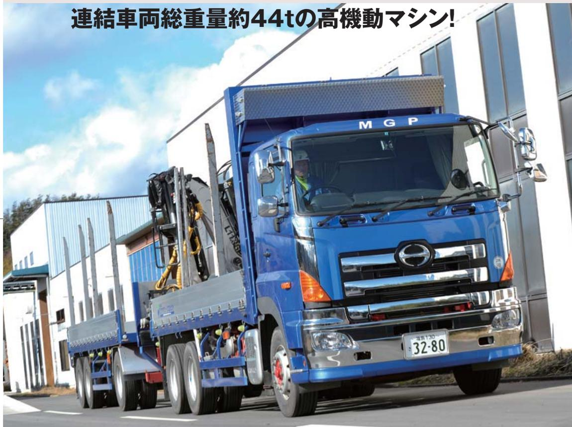
走行感覚はほぼトラックに近い。連結車両総重量は約44tにもおよぶが、高速道路の走行にも十分な動力性能だ
