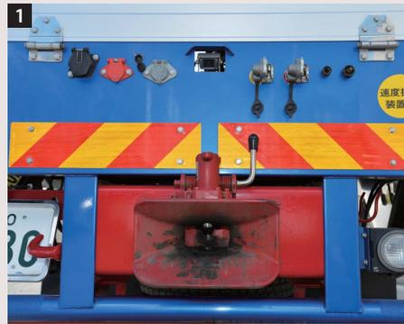
1 フルトラクター最後部に備わる連結装置。牽引バーをピンで固定するシンプルな構造。2 連結時はまず、トラクターをトレーラーへアバウトに近づけていく。3 ケーブル類を接続し、ギヤをバックに入れると牽引バーがフリーロックとなり連結装置に合わせて稼働させる。通常のフルトレではこうはいかない。4 トラクターをバックさせて連結。5 こんなにずれていても簡単に連結可能だ
