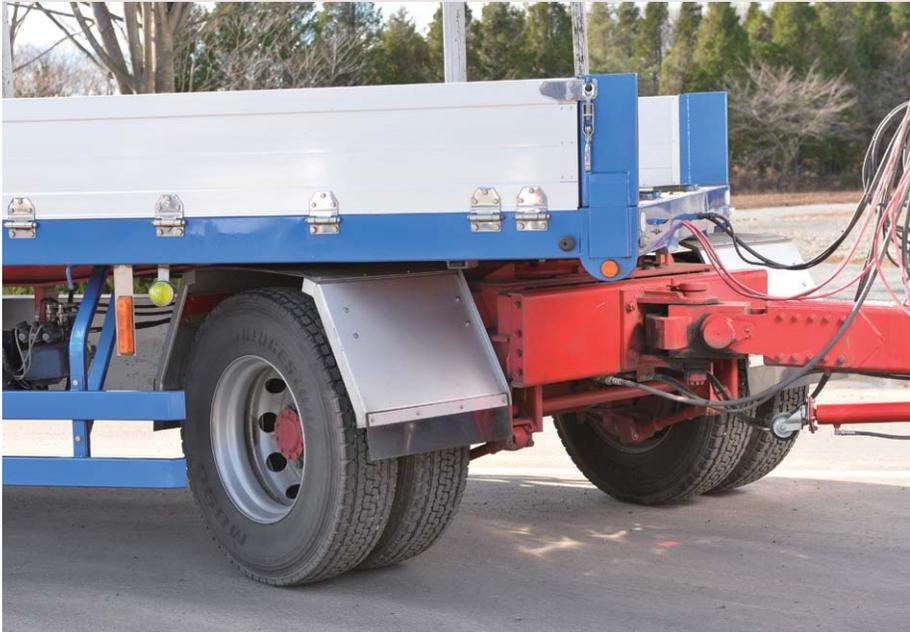
フルトレラー前軸は車軸ごと左右に操舵されることで、トラクターをトレースするように走行する
