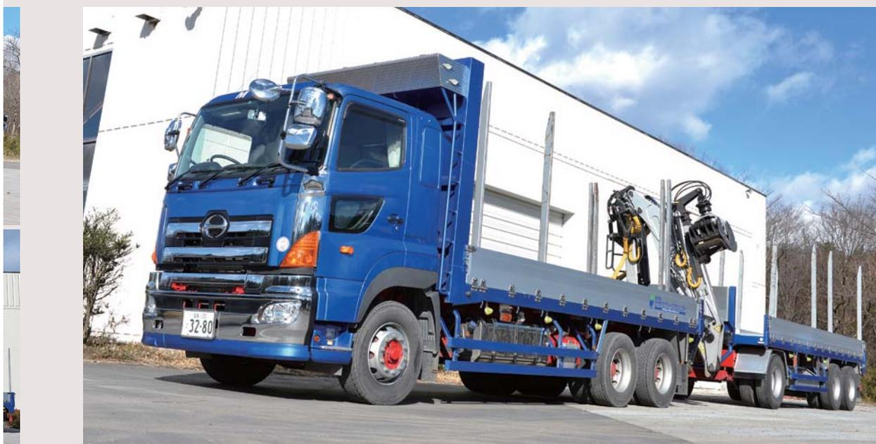
トラックをベースに牽引装置を取り付けたフルトレーラ
