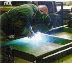
▲ボディの製作風景。スウェーデン鋼を大型プレス機でコの字型に折り曲げ、強度を高めた後に組み上げる。
