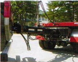
▲トレーラ前輪を2本の油圧シリンダーで操舵する独自開発の牽引装置。
