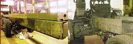
▲ボディづくりには軽量で普通鋼の3倍から5倍の強度をもつスウェーデン鋼を使用。軽量化により積載量のアップ、輸送効率の向上を実現した。重要な部分はリベットで止める。同社は基本的にフレームへの溶接はしない。「溶接すると丈夫になる反面、ざっくり破損する場合がある。当社は強さと柔軟性を兼ね備えたリベット止め。経験工学ですね」。
